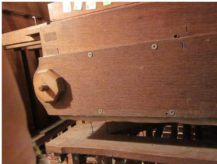
Windlade die onoordeelkundig is gerepareerd: de kruiskopschroeven waren niet nodig geweest en passen ook niet bij het oude werk.
