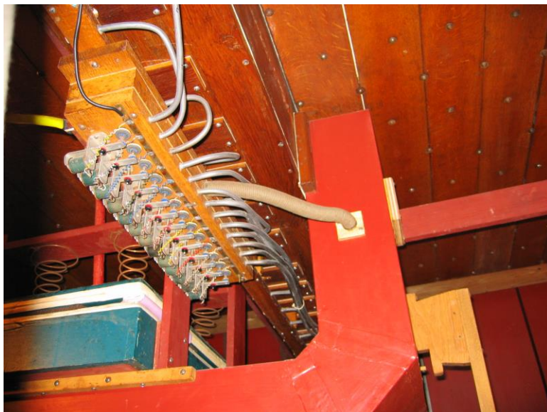
Een elektro-pneumatisch orgel maakt meteen een andere indruk: een stelsel van elektromagneten, kleine schijven of kegels, smalle buizen met lucht onder druk en membranen zorgt voor het transport van de toetsbeweging naar de lade. Voor de organist heeft dit systeem als nadeel dat hij het ventiel niet meer voelt. Het voordeel is dat de toetsdruk licht blijft, ook bij de grootste orgels.
