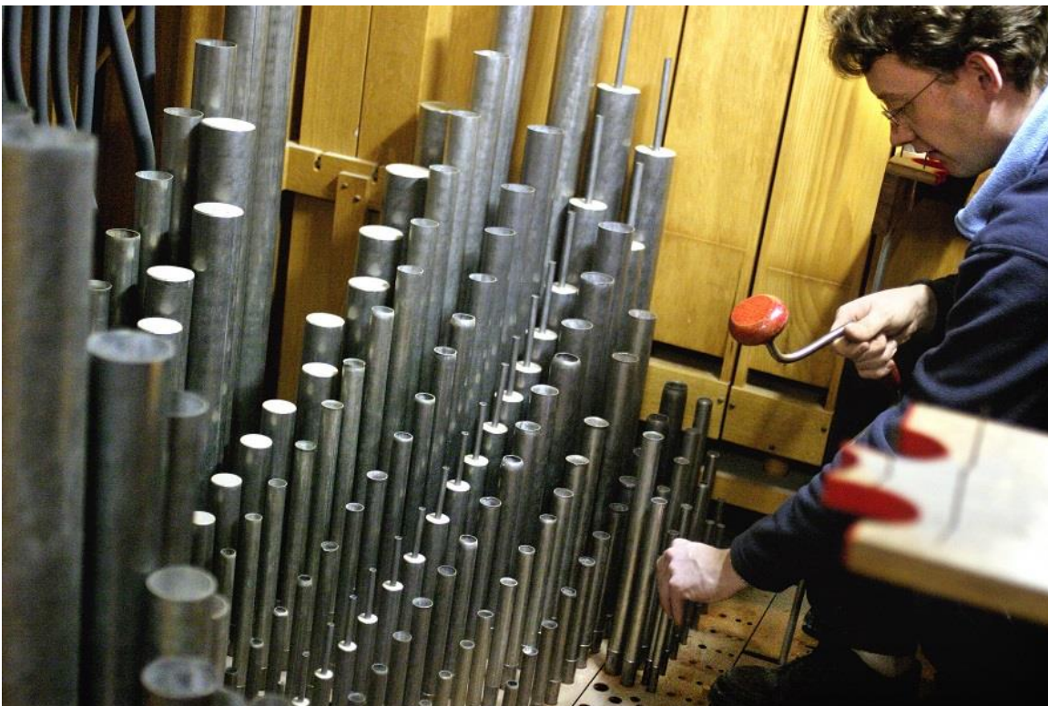
Alle pijpen worden weer op hun plaats gezet, en tegelijkertijd vindt de afwerking van de klank (intonatie en stemming) plaats.
