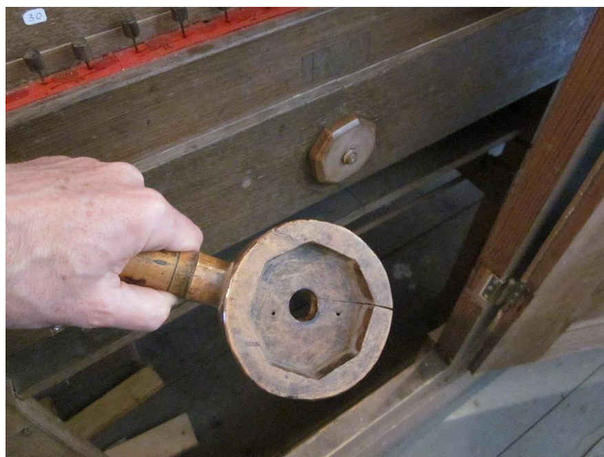
Bij dit orgel bleef een uniek stuk gereedschap bewaard: een palmhouten sleutel voor het los- en vastdraaien van de achthoekige moeren waarmee de voorslagen op hun plaats worden gehouden (Abbekerk).
