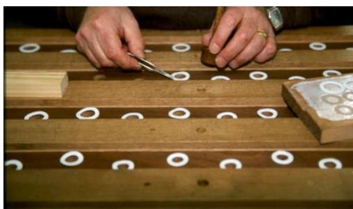
Om de laden beter bestand te maken tegen schommelingen in temperatuur en vochtigheid, worden ze, na te zijn hersteld, voorzien van stoffen ringen.
